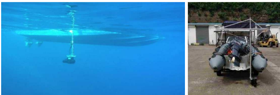
Fig. 26 – SMF Norbit iWBMSH intégré au système déployable d'hydrographie
